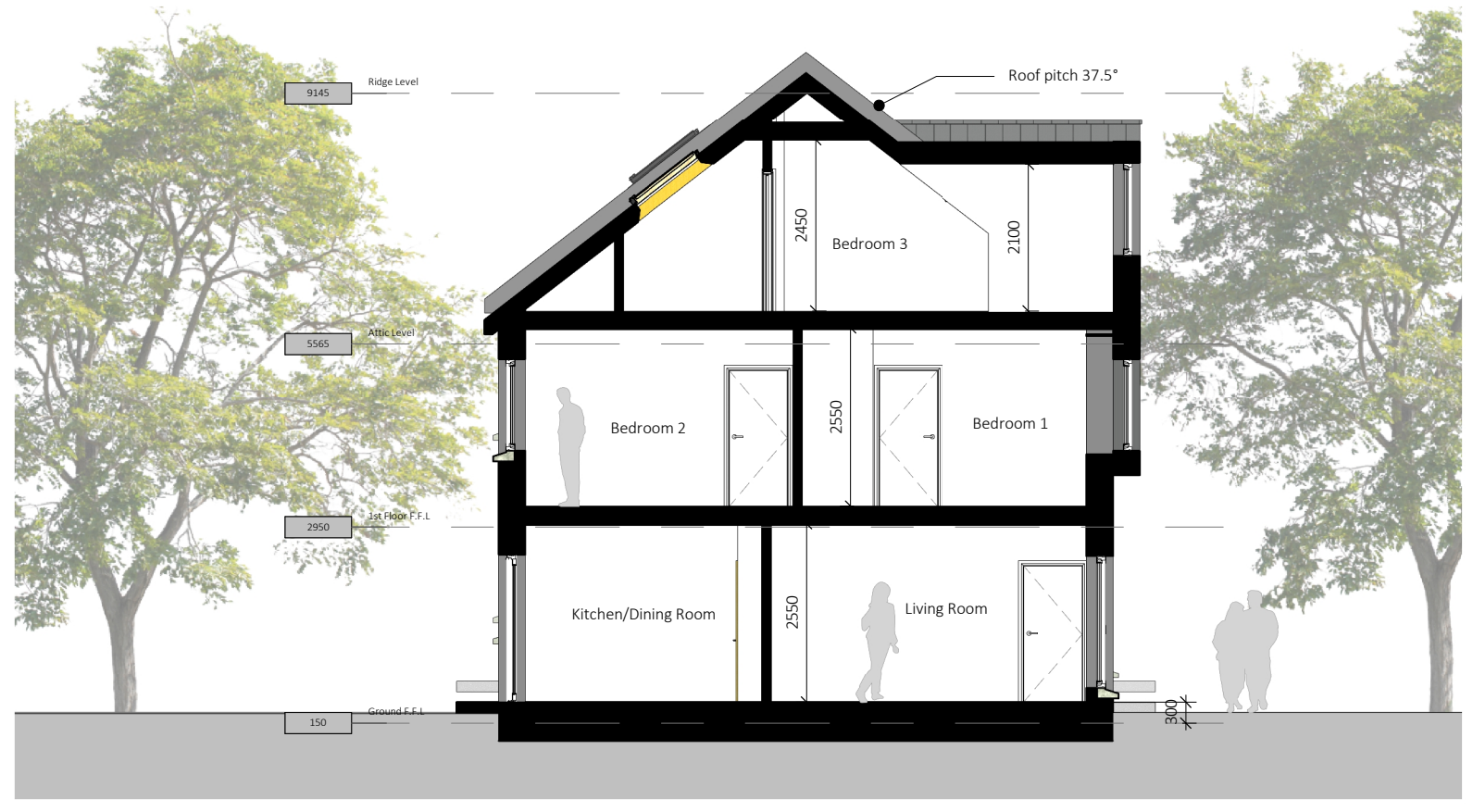
Cross Section A-A 1:100
